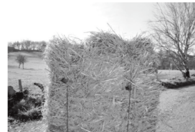
Botte de paille brute. Une partie de la paille fait une bosse entre les ficelles. Cette paille en excès est utilisée pour rectifier la botte.
